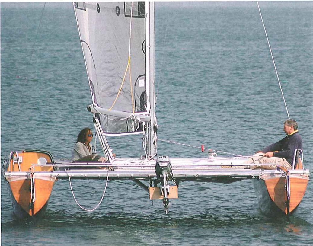
Deutlich ist hier die tiefe Spantform der Rumpfe zu erkennen, die ausreichend Lateralwiderstand bringt, sich aber mit geringstem Fahrtwiderstand durchs Wasser bewegt. Die Wellenbildung an den Rumpfen ist minimal.
